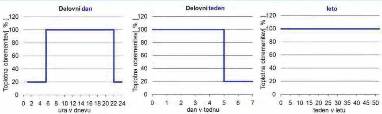
Slika 16: Stalna potreba po topotni energiji industrijske kopeli v manjšem podjetju (npr. temperatura elektrolita mora biti stalna).
