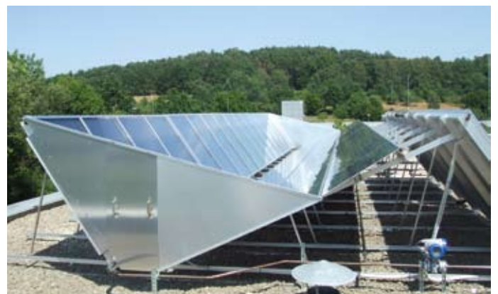
Abb. 21: Prototypen verbesserter Flachkollektoren mit doppelter Frontverglasung (Glas und Folie) und externen Reflektoren).
